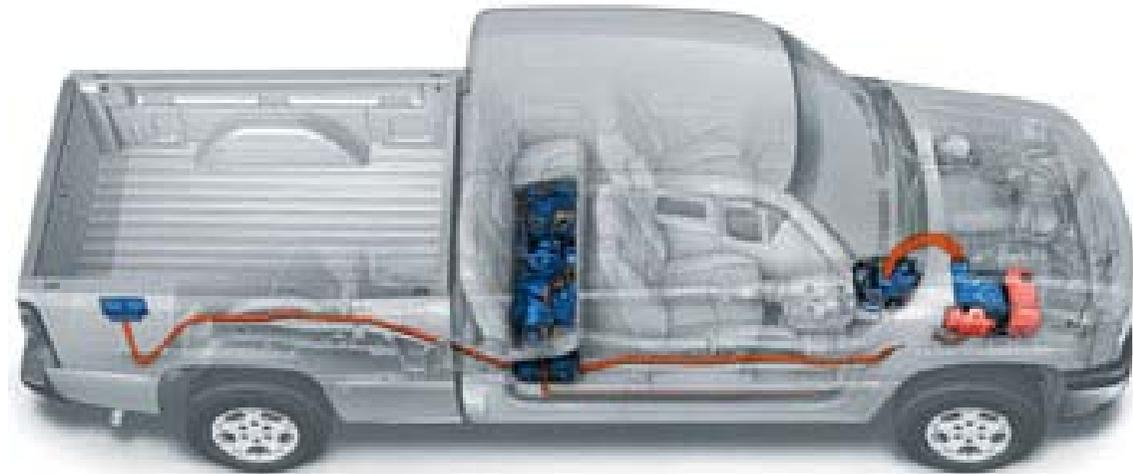
Verschieben sich die Leistungsschwerpunkte von Elektromotor (↗) und Verbrennungsmotor (↘) und wird der Energiespeicher optimiert, spricht man von Full-Hybrid (auch Strong-Hybrid):
